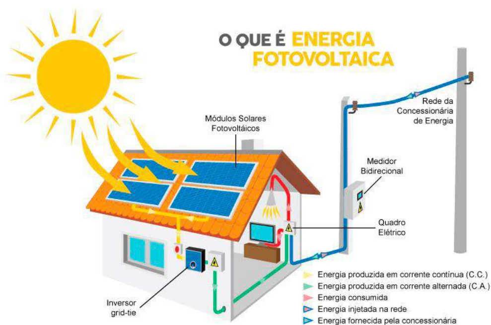
Figura 53: Sistema de Energia Solar
