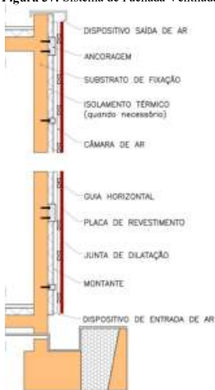
Figura 37: Sistema de Fachada Ventilada
