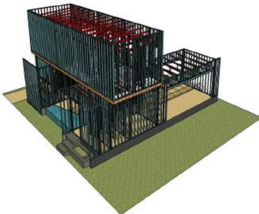
Figura 40: Projeto estrutural adaptado para Light Steel Frame
