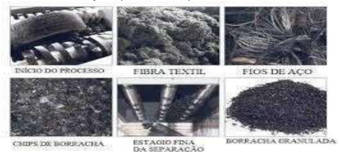
Figura 4 – Fases de transformação do pneu em matéria prima de asfalto
