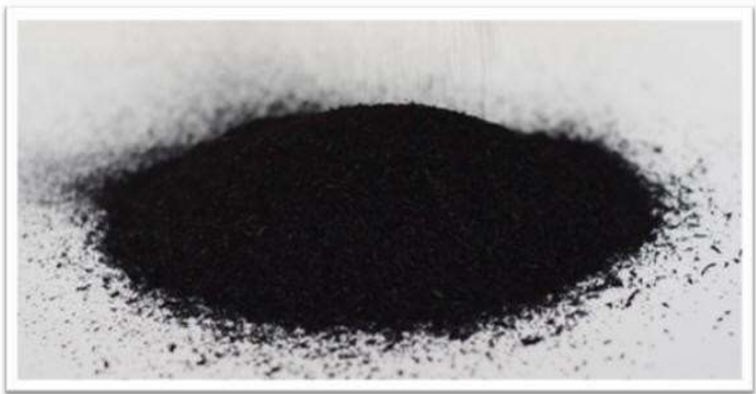
Figura 5 - Borracha derivada do pneu pronta para receber o ligante asfáltico
